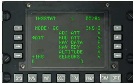
Abb. 148: System / INS / INSSTAT Seite
