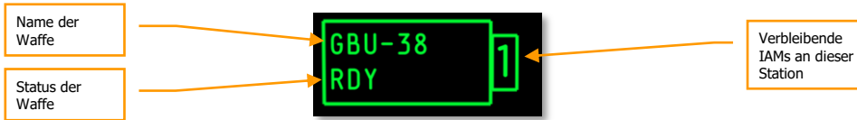
Abb. 446. GBU-31 Statusinformation: Einsatzbereit
