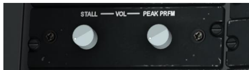
Abb. 121: Kontrollen für Strömungsabriss-Warnung
