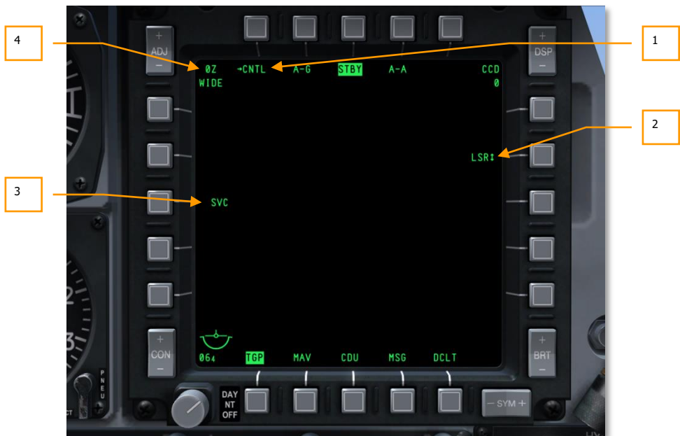
Abb. 242: TGP Standby Seite
