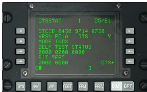
Abb. 170: System / DTSSTAT Seite
