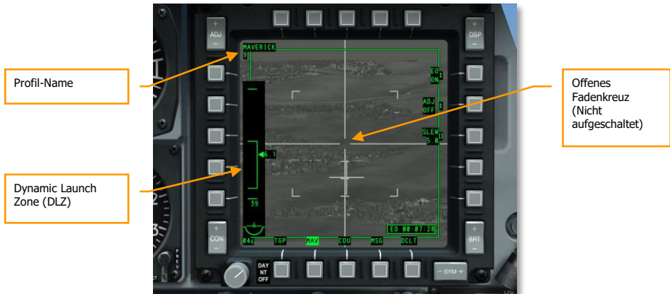
Abb. 461. Maverick im Waffenmodus, Keine Zielaufschaltung
