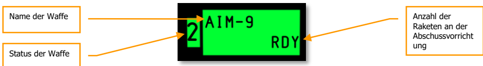
Abb. 466. AIM-9 Station Info-Box: RDY (bereit)
