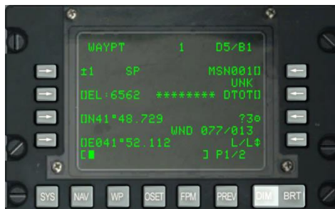
Abb. 195: Waypoint Seite im TO TO Navigationsmodus
