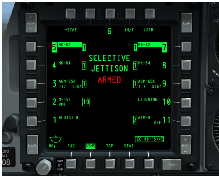
Abb. 223: DSMS Seite für selektiven Notabwurf
