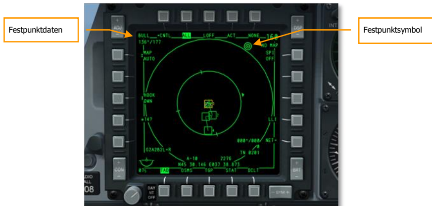
Abb. 354: TAD Display mit Festpunktinformationen
