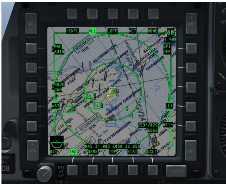
Abb. 285. MFCD Seite als aktiver Sensor (SOI)
