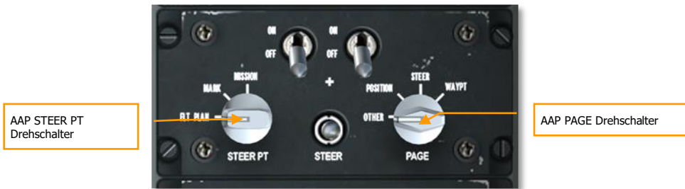
Abb. 342. Hilfsavionikpanel (engl. AAP)
