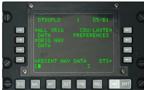
Abb. 168: System / DTS Upload Seite
