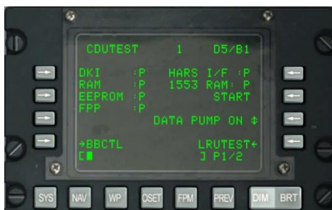
Abb. 176: System / CDU Test Seite 1
