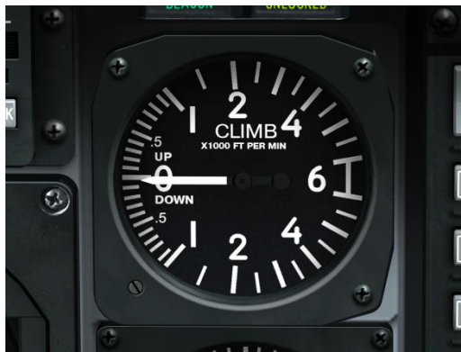
Abb. 98: VVI (dt: Variometer)
