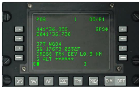
Abb. 147: System / INS / POS Seite
