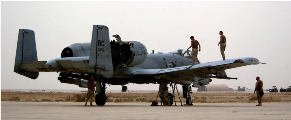
Abb. 29: A-10 Thunderbolt II Wartungsmannschaft inspiziert ein Flugzeug, welches im Einsatz im Irak von einer Rakete getroffen wurde
