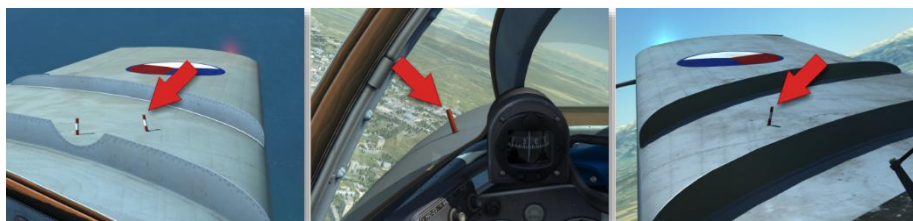
图 3.13. 机翼上的机械指示杆在起落架完全放下时伸出： 左、前、右
