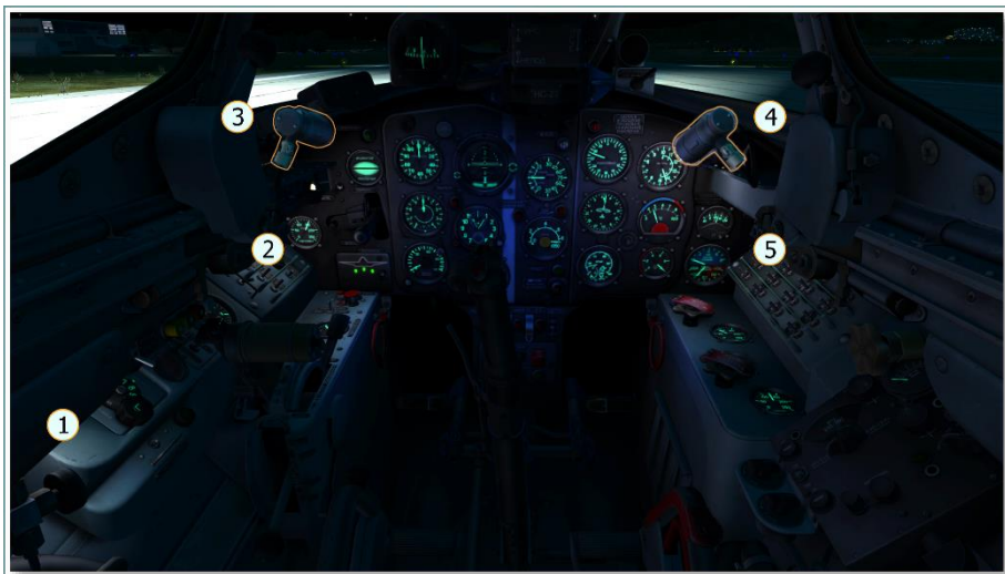
图 5.19. MiG-15bis 驾驶舱照明灯位置
