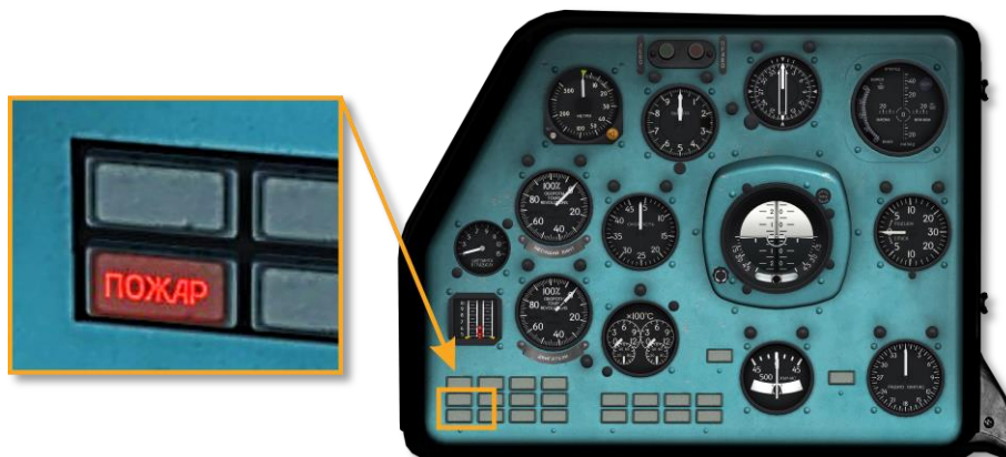
Fig. 7.28. Lamp ПОЖАР (FIRE) on the left dashboard
