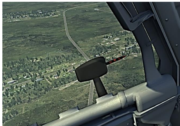
Fig. 7.20. Visual Ice Detector
